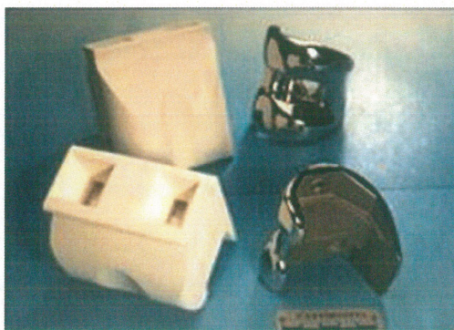
10-сурет-Үш өлшемді басып шығарумен жасалған керамикалық қалыптың көмегімен медициналық кобальт қоспасынан жасалған тіздегі ортопедия
